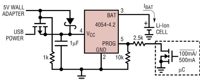
采用外部功率耗散的 800mA 锂电池充电器
