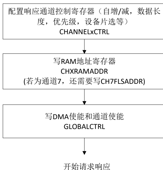
图 17-2 DMA 寄存器配置
