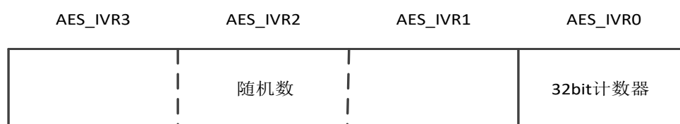
图 9-8 32 位计数器和随机数的存储方式
