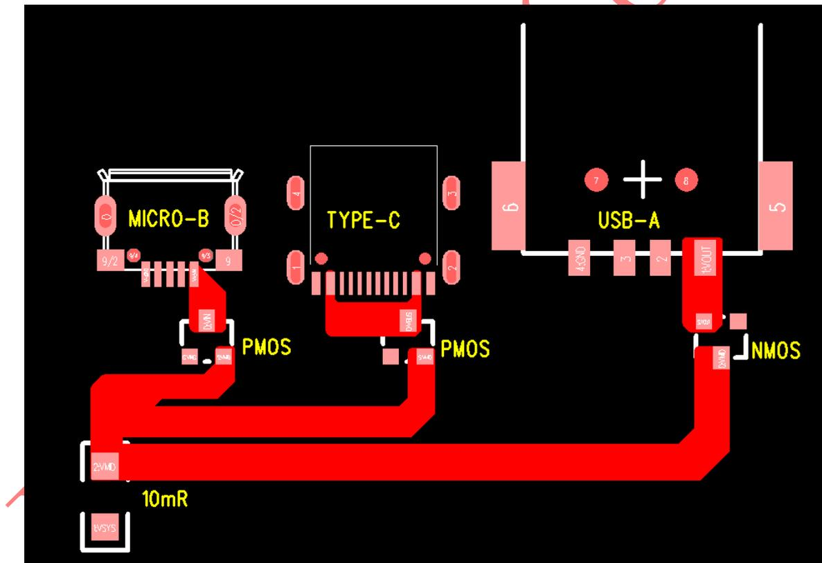
假如错误的 Layout 导致 VOUT 与 VBUS 的输出电流有 1 毫欧的重合走线，当 VBUS 上有 2A 电流输出时，重合的 1 毫欧走线上会产生 2mV 的压差，这种情况下即使拔掉 VOUT 上的设备，也无法判断出 VOUT 上的设备拔掉了，也就无法恢复 VBUS 输出出口的快充功能。需要待 VBUS 输出出口的电流小于 1.8A，重合的 1 毫欧走线上产生的压差小于 1.8mV 持续 16ms 才能够自动恢复 VBUS 输出出口的快充功能。
