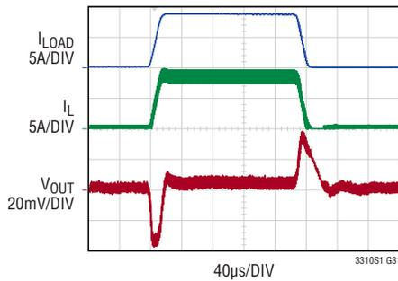
3.3V<sub>IN</sub> TO 1.2V<sub>OUT</sub>, 2MHz
