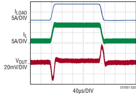
3.3V<sub>IN</sub> TO 1.2V<sub>OUT</sub>, 2MHz
