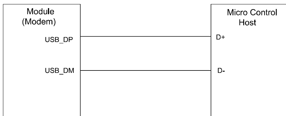
图3-10 USB 推荐电路图
