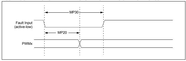
FIGURE 25-10: HIGH-SPEED PWMx MODULE TIMING CHARACTERISTICS
