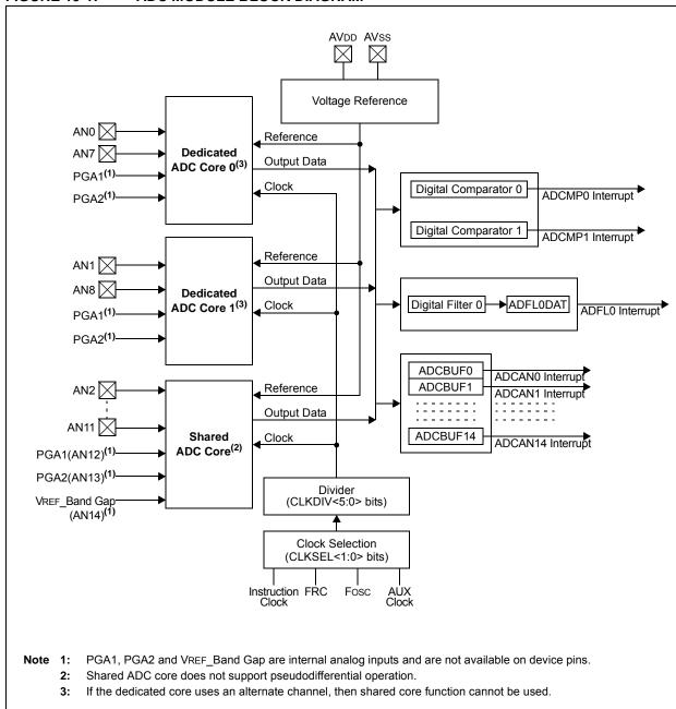
FIGURE 19-1: ADC MODULE BLOCK DIAGRAM
