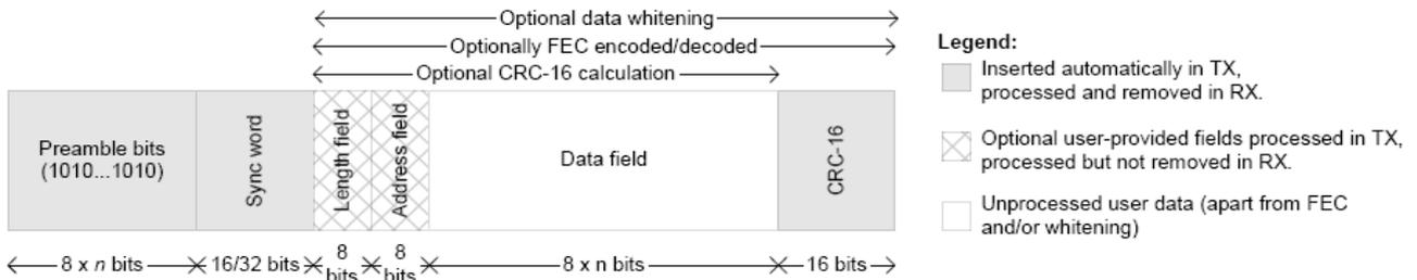
此外，CC1101 支持固定数据包长度、可变数据包长度和无限长数据包长度的传输方式，不同的数据包长度，其配置和控制方式也不一样，详细情况请参阅 CC1101 芯片规格书。
