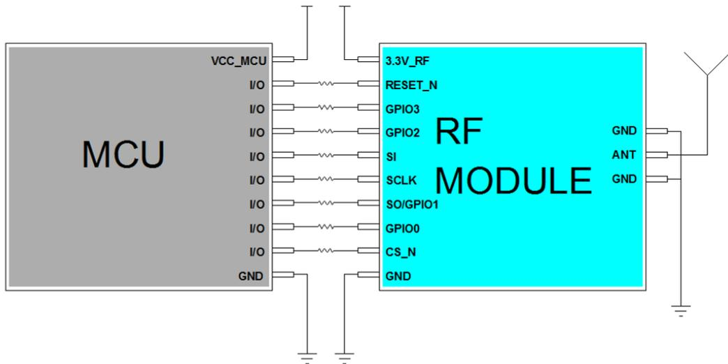
注：以上模块引脚排列并非按实际排列，引脚排列请看引脚定义。SPI、数据输出接口请与MCU实际功能引脚连接，电路中请做好ESD保护，防止因引脚输入造成电路损坏。模块要求的天线阻抗为50欧姆，建议在天线出口与天线之间请加入 $\pi$ 形匹配电路，以便调整因外壳结构等引起的天线不匹配问题。其它还要注意模块布局、地线分布、天线安装。天线布局详情参考下图，有不明之处可与我司技术人员联系。
