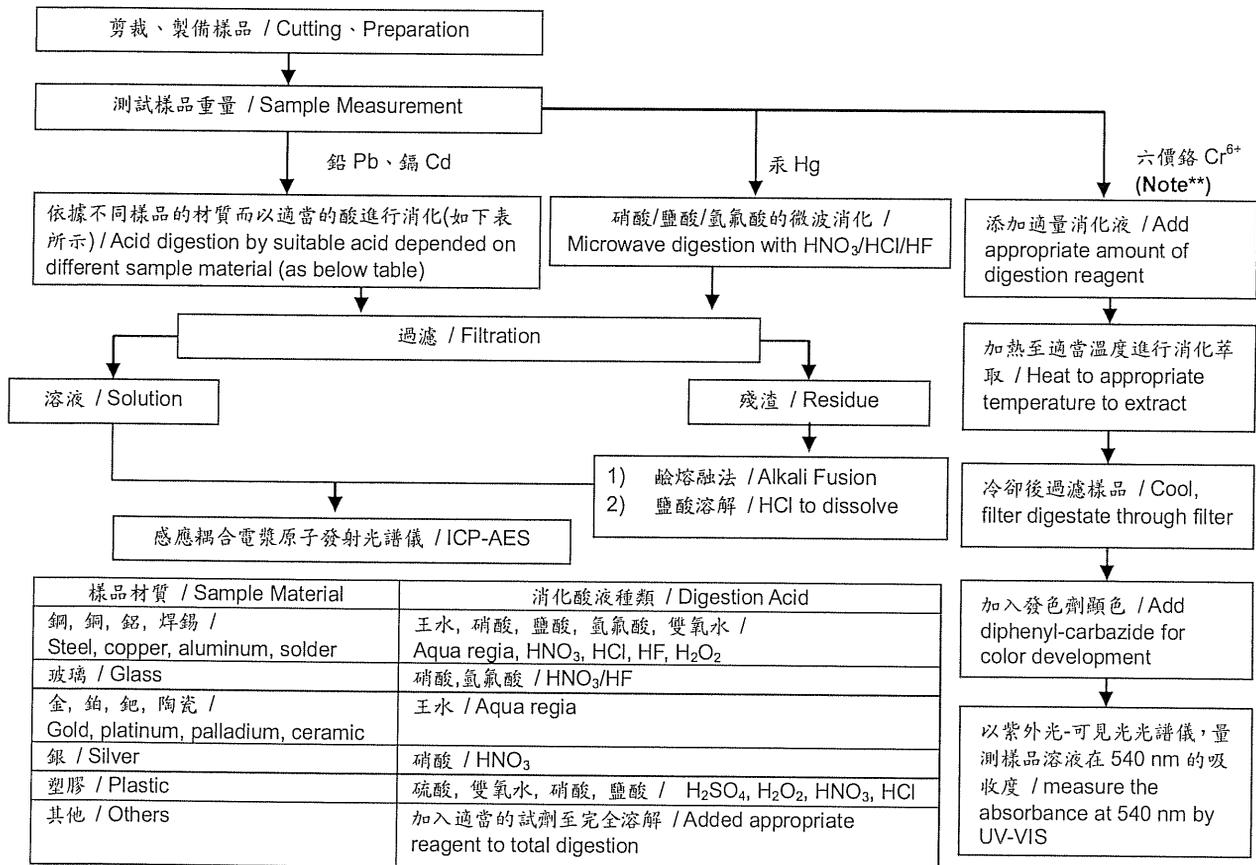
Note\*\*: (1) 針對非金屬材料加入鹼性消化液，加熱至 90~95℃ 萃取。 / For non-metallic material, add alkaline digestion reagent and heat to 90~95℃.
