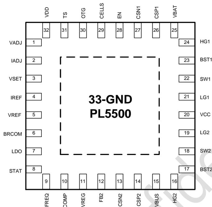
Fig. 2 Pin-Function (QFN4X4-32)
