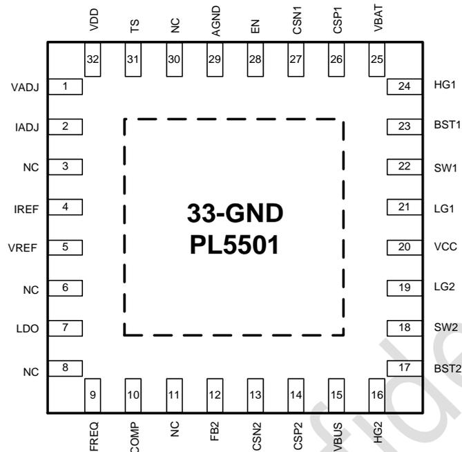
Fig. 2 Pin-Function (QFN4X4-32)
