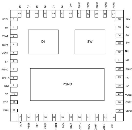
Fig. 3 Pin-Function (QFN6X6-48)
