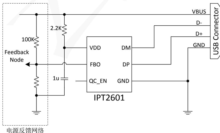
注: QC\_EN 脚悬空时快充最高响应电压为 9V/12V, QC\_EN 脚接 VDD 时快充最高响应电压为 12V
