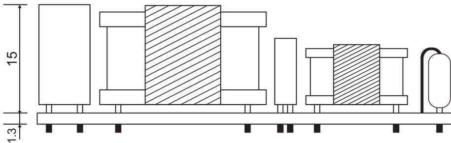
注: 此图为PCB导出尺寸, 误差为(±1mm)详细尺寸请根据实物为准
