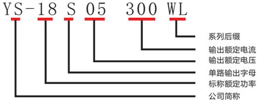
YS-18SWL系列是高可靠性,输出高达20W基板插针式单路输出电源,适合输入电压85~265VAC应用,可根据客户需求设定不同电压,可适应多种消费类电子设备需求。
