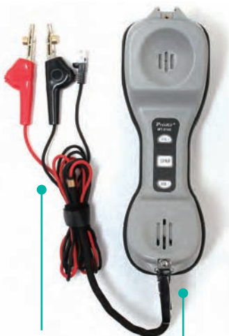
电信专用鳄鱼夹 穿刺型,免剥线
