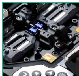
THK滑轨, 准确调芯 Smart ARC 动态放电校正
