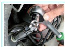
72 段快拆式棘轮扳手 搭配万向接头
