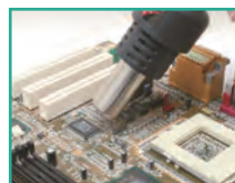
SMD 热风拆焊作业
