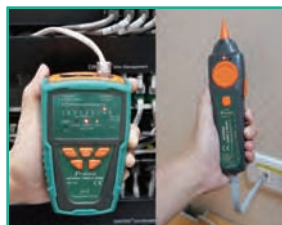
导通、短路、断路式错接
