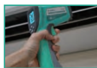
冷气空调出风口 温度测试
