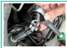
72 段快拆式棘轮扳手 搭配万向接头
