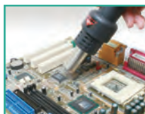
SMD热风拆焊作业
