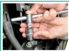
T型滑动式手柄搭配万向接头
