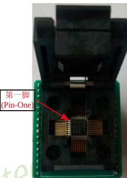
LQFP-32封装的单片机安装图
