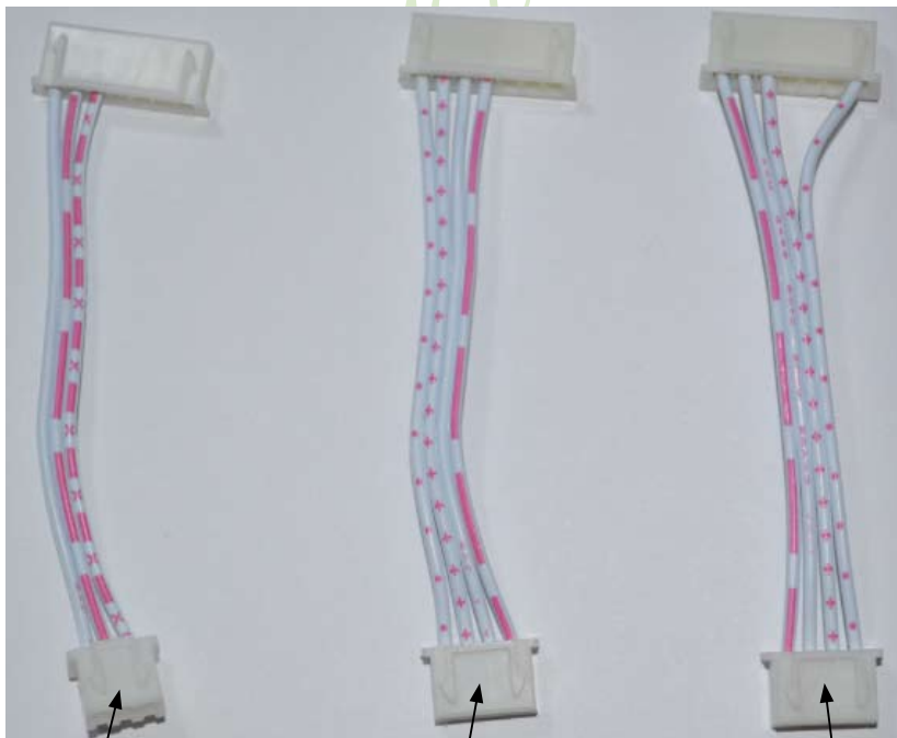
U8W/U8W-Mini/U8/ U8-Mini与用户系统各 自独立供电的连接线
