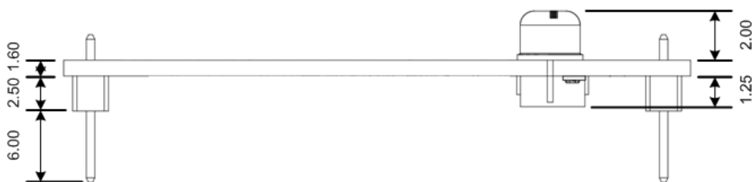
图 0.2 ZNE-100TA 模块侧视图及机械尺寸（单位：mm）
