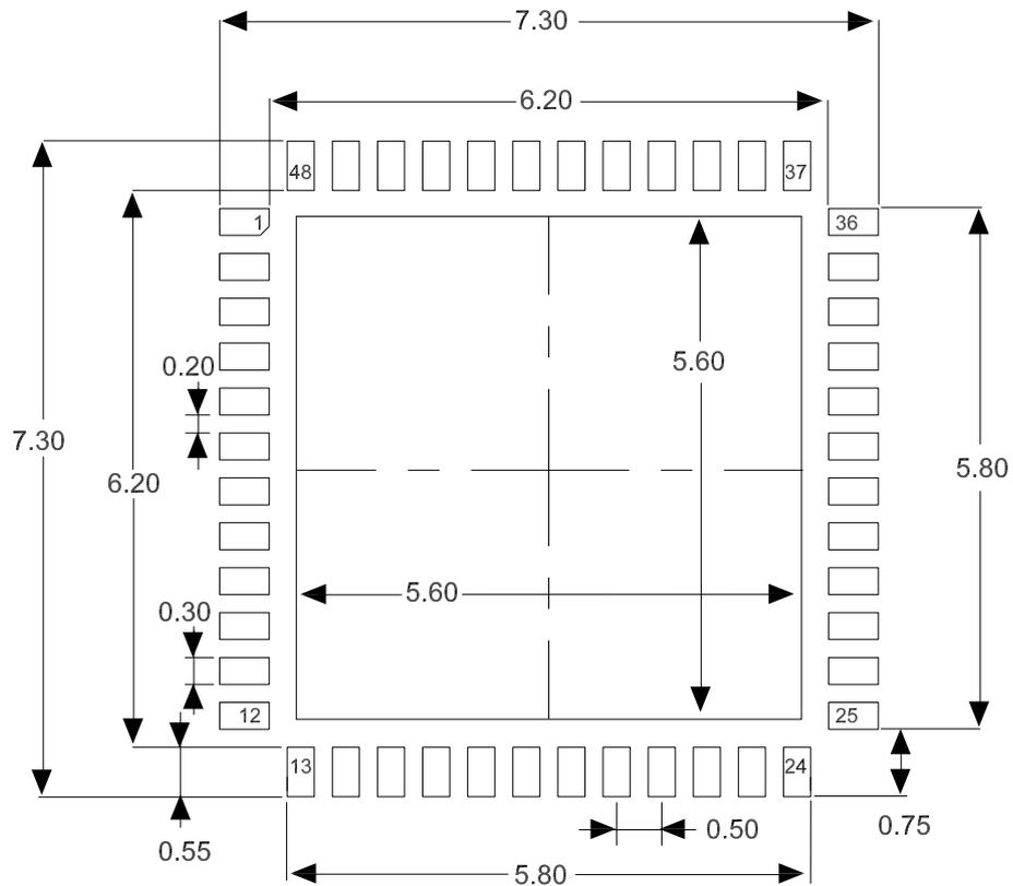
图 27 QFN48 打码规范
