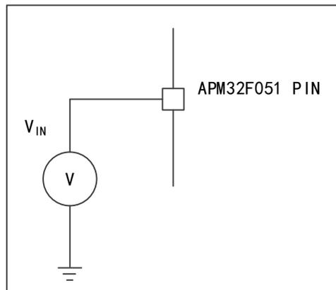
图 11 电流消耗测量方案
