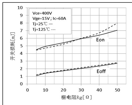
图 6 开关损耗-栅电阻特性曲线
