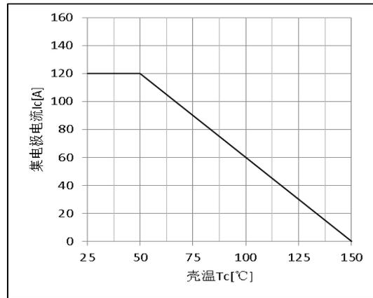
图 16 集电极电流温度特性
