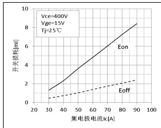
图 12 开关损耗的电流特性
