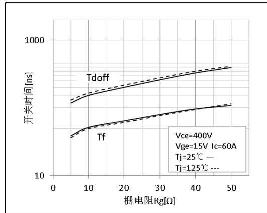
图 8 关断-栅电阻特性曲线
