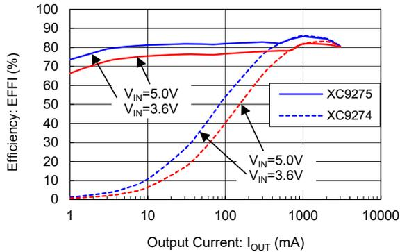
XC9274x06C / XC9275x06C ( $V_{OUT}=1.2V$ )
