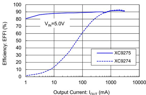
XC9274x06C / XC9275x06C ( $V_{OUT}=3.3V$ )
