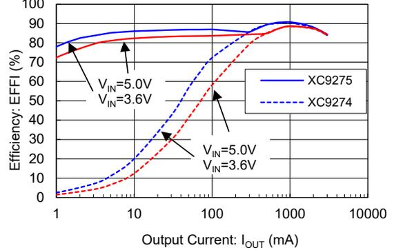
XC9274x06D / XC9275x06D ( $V_{OUT}=1.8V$ )
