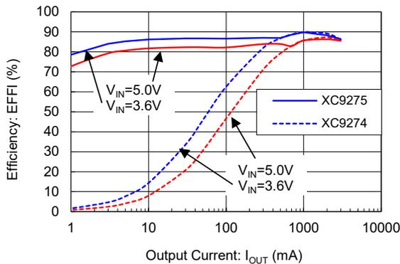
XC9274x06C / XC9275x06C ( $V_{OUT}=1.8V$ )
