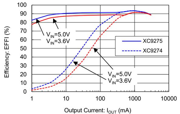
XC9274x06D / XC9275x06D ( $V_{OUT}=3.3V$ )
