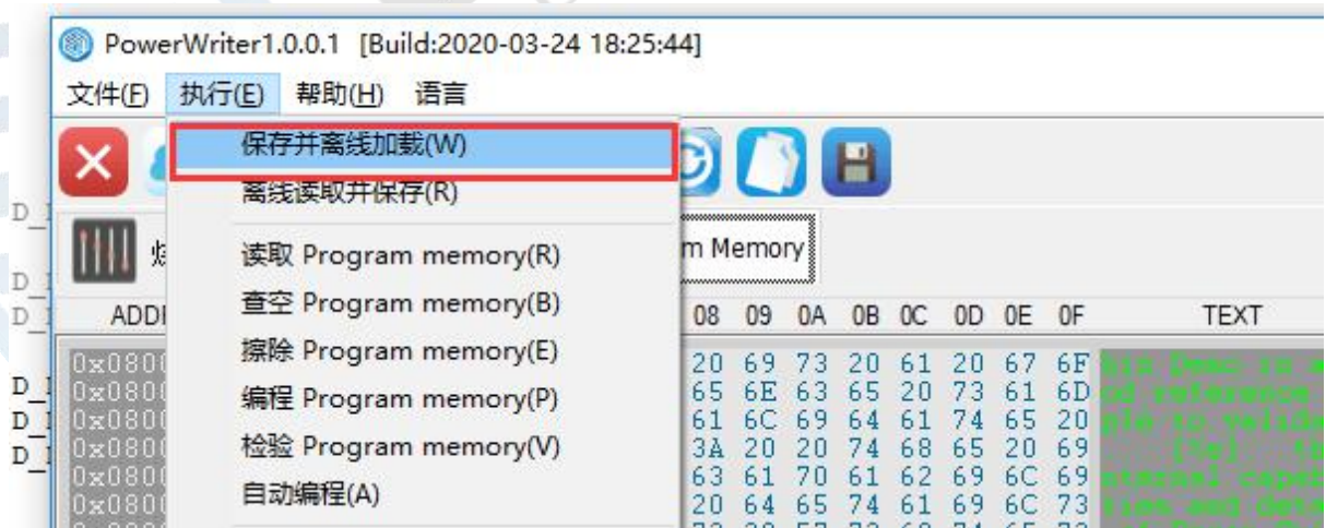
图 4.2.2-4 将项目保存到本地并离线加载到 Power Writer
