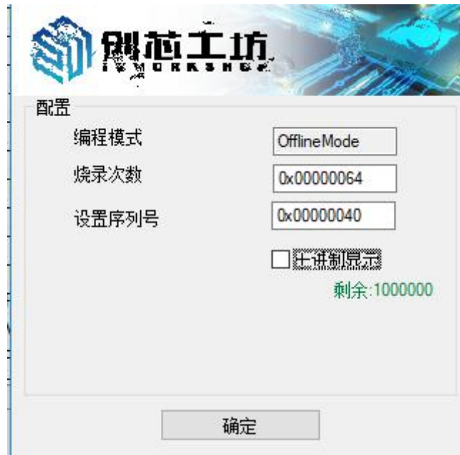
图 4.3.1-4 Power Writer 的烧录参数配置
