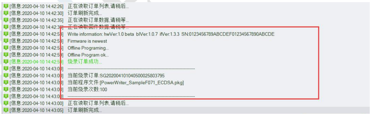
图 4.3.1-5 创芯工坊将 Power Writer 项目以离线方式加载到 Power Writer
