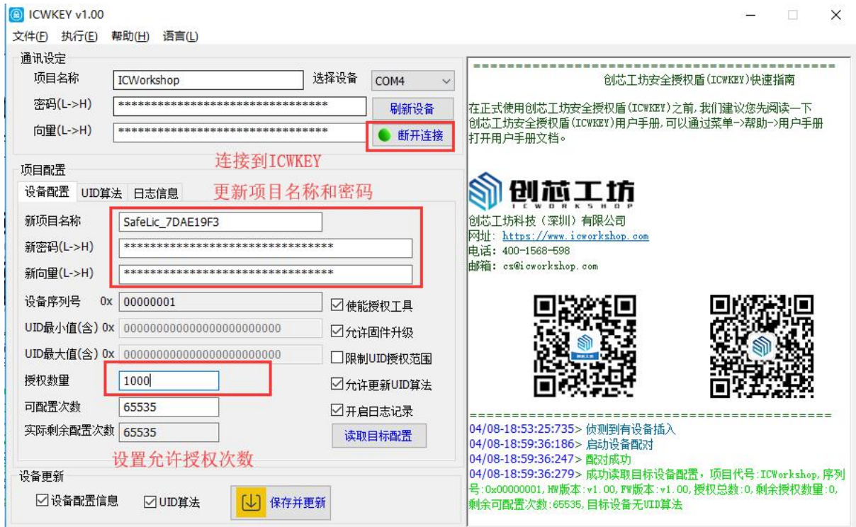
图 4.2.4-4 ICWKEY 同步设置 Power Writer 端设置
