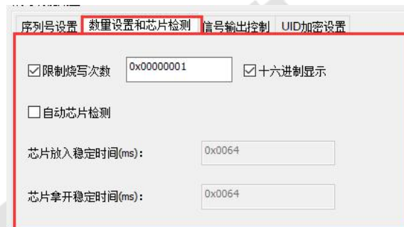
图 3.1.4.1.2.2 Power Writer 数量设置和芯片检测
