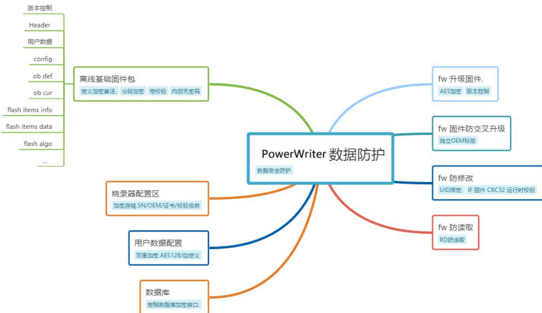
图 2.3.4.1 Power Writer 数据安全防护一览图
