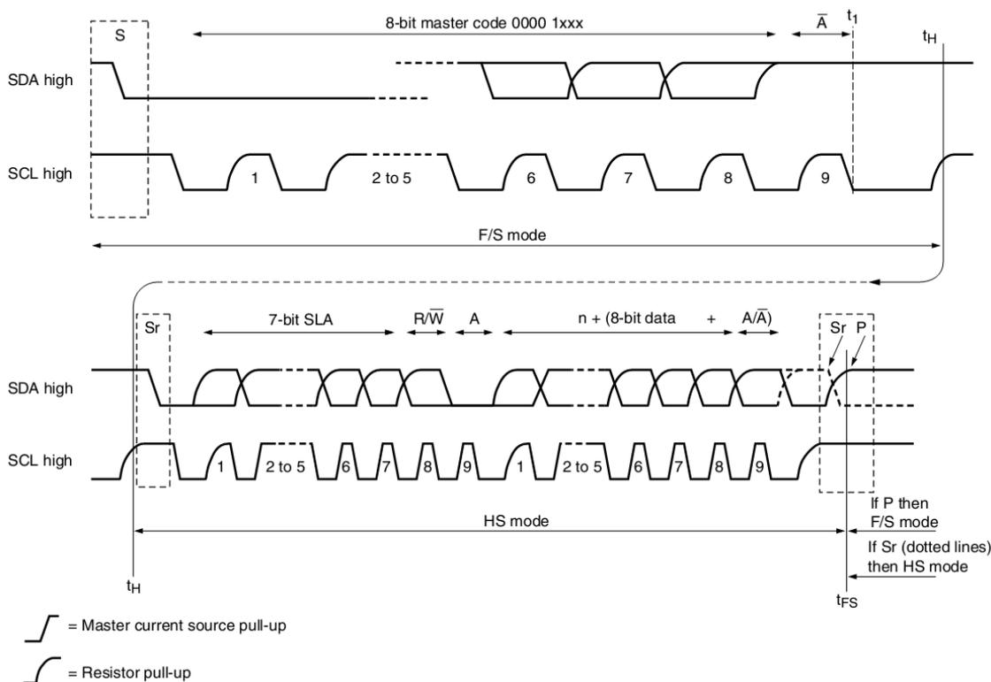
图 4-11 I2C 总线 HS 模式协议帧格式
