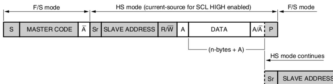
图 4-10 I2C 总线 HS 模式协议转换
