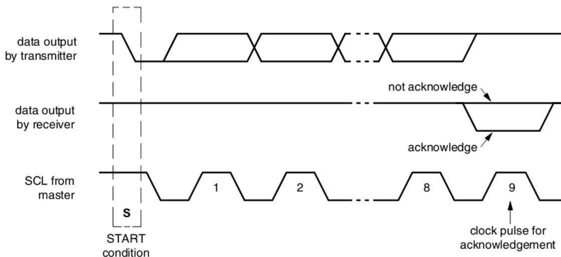
图 4-6 I2C 总线上的 acknowledge 信号
