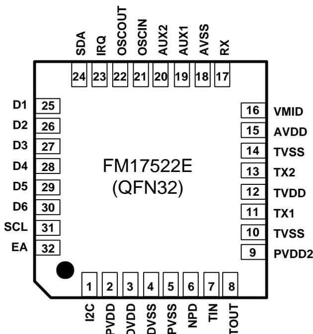
图 1-2 FM17522E QFN32 封装引脚图 (TOP VIEW)
