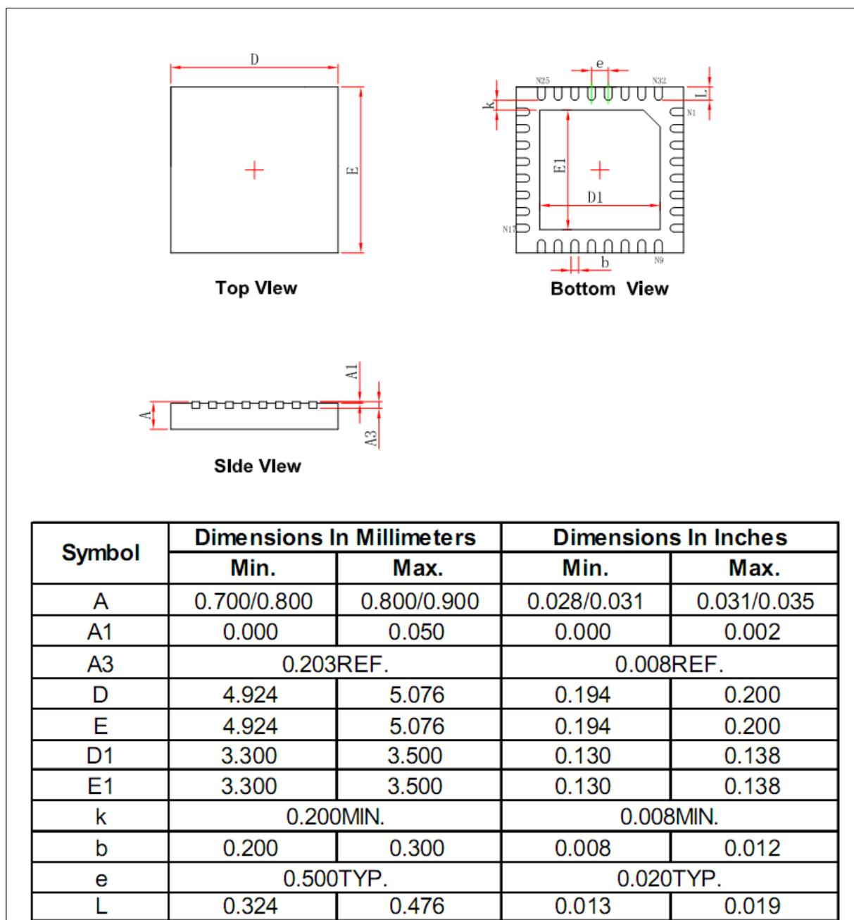
图 19-1 FM17522E QFN32 封装尺寸图
