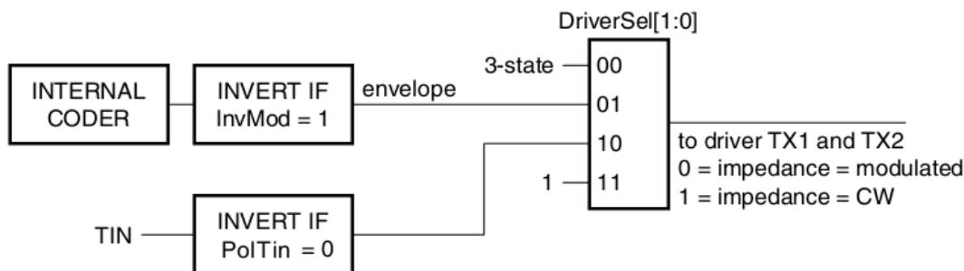
图 5-1 TX1 和 TX2 间串行数据转换
