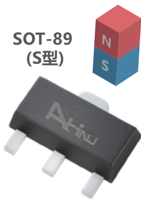
S极触发低电平
