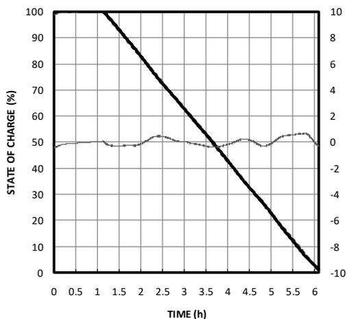
**SIMPLE C/2 RATE DISCHARGE SOC ACCURACY**
