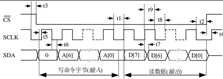
图 6-2 读操作时序 2(除 AD 值之外的寄存器)
