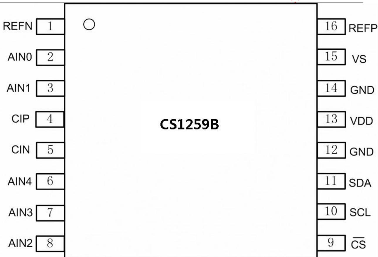
图 1-2 CS1259B SOP16 封装引脚图
