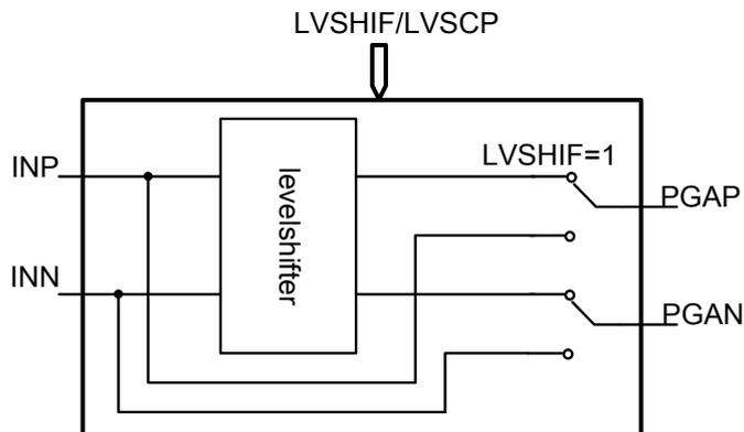
图 3-2 电平移位模块
