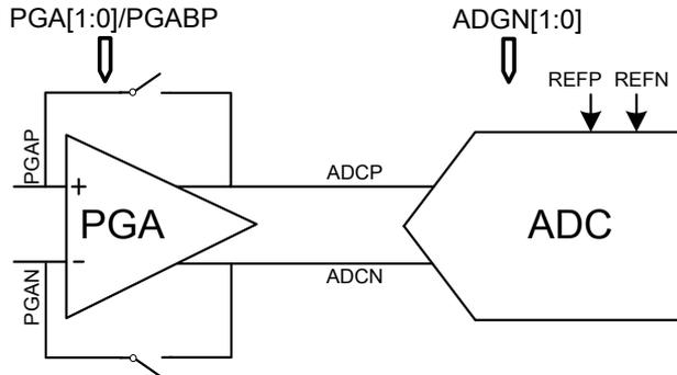
图 3-3 PGA 和 ADC 结构图
