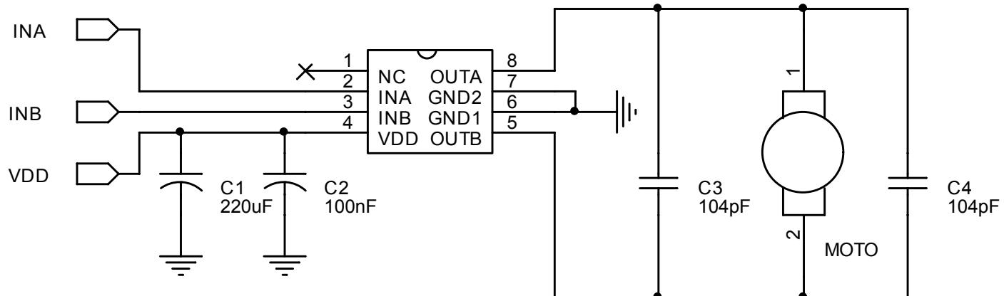
注: 在不同的应用中, C1、C2 可考虑只装一个: 在 3V 应用中建议用一个 1uF 或以上; 在 4.5V 应用中建议用一个 4.7uF 或以上, 均为使用贴片电容; 在 6V 应用中建议用一个大电容 220uF+100nF 贴片电容; C2 均靠近 IC 之 VDD 管脚放置且电容的负极和 IC 的 GND 端之间的连线也需尽量短。即不要电容虽然近, 但布线、走线却绕得很远 (参考下图)。当应用板上有大电容在为其它芯片滤波时且离 TC118A 较远也需按如上要求再放置一个小电容于 TC118A 的 VDD 脚上。图中 C4 (100nF) 电容优先接于马达上, 当马达上不方便焊此电容时, 则将其置于 PCB 上(即 C3)。
