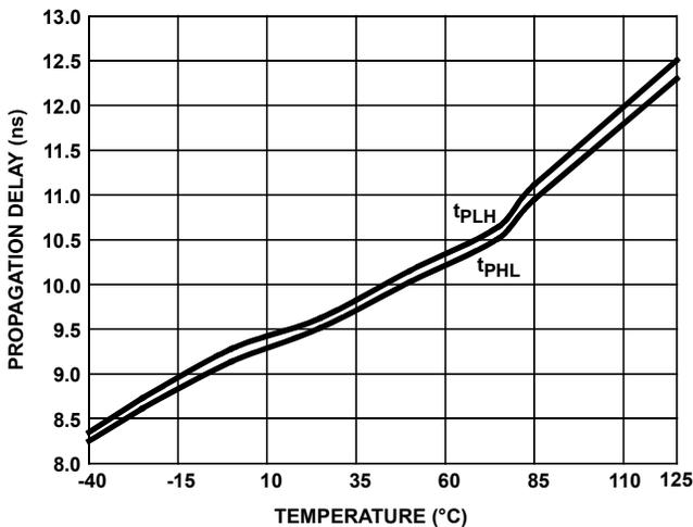
FIGURE 12. DRIVER DIFFERENTIAL PROPAGATION DELAY vs TEMPERATURE
