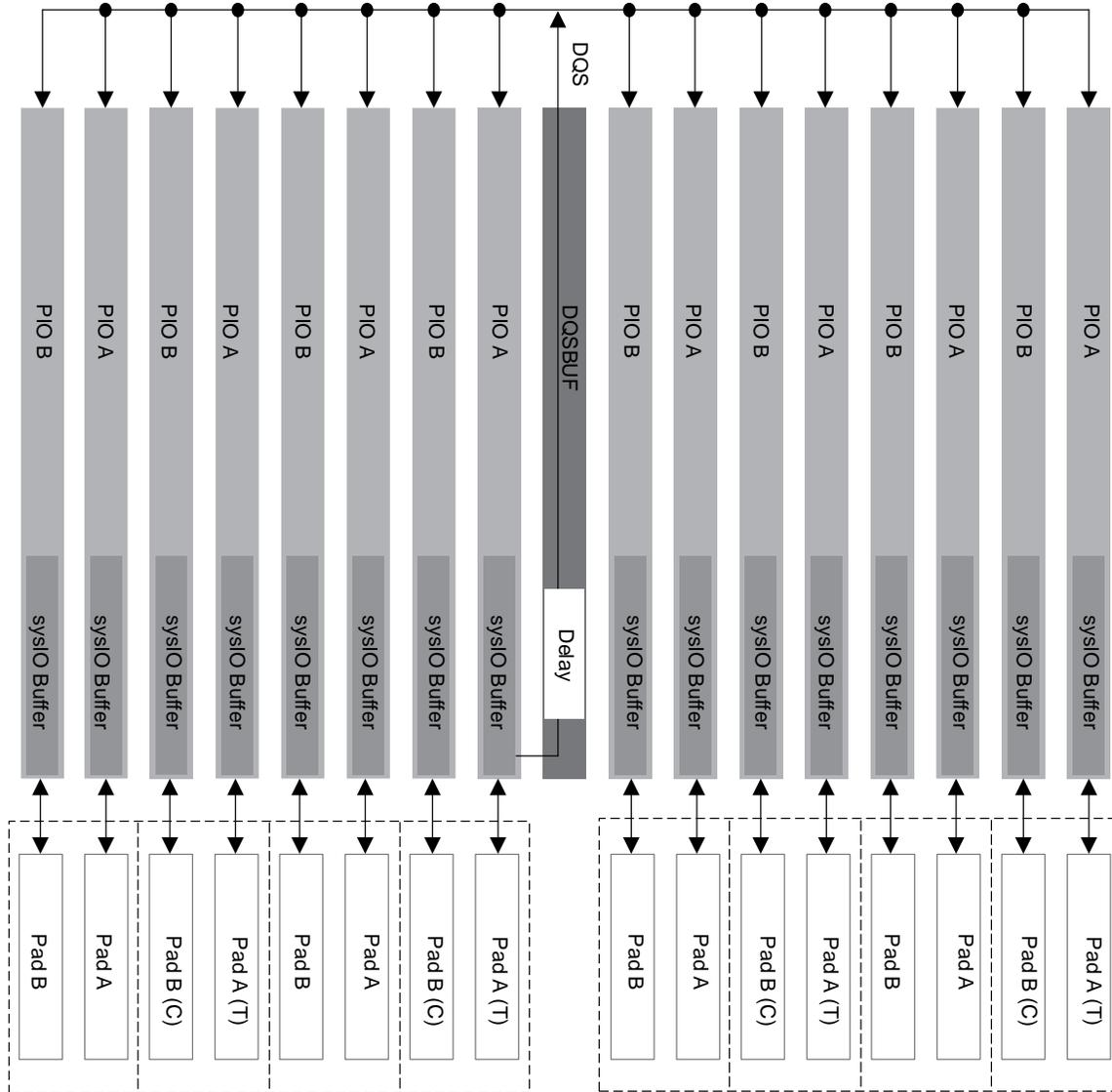
Figure 2.25. DQS Grouping on the Bottom Edge
