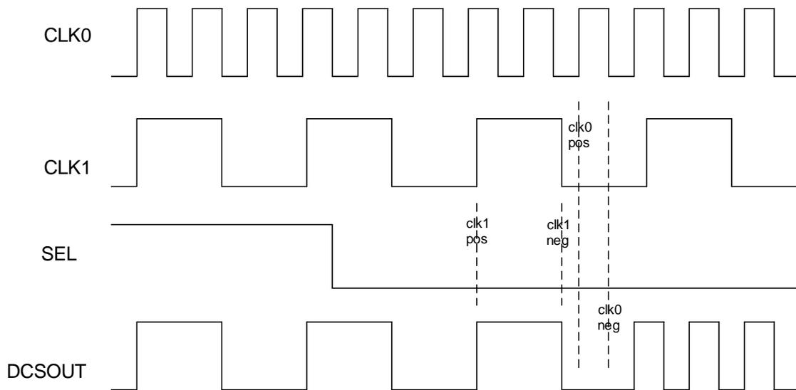
**Figure 2.10. DCS Waveforms**
