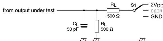
**Figure 22. Load Circuit**
