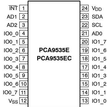
Figure 3. SOIC24 / TSSOP24
