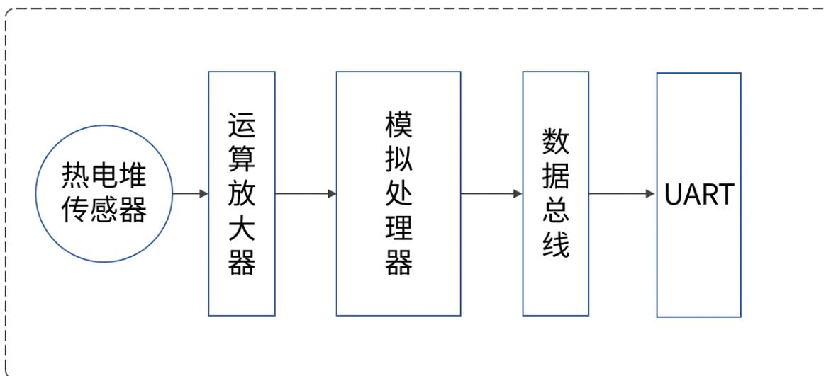
图 1. 模块结构图 (外观尺寸可定制)
