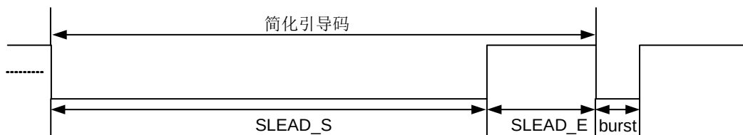
图12-39 NEC with simple repeat code 码连发代码格式
