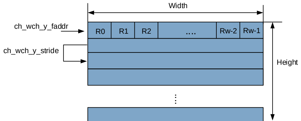
图9-13 RAW DATA 的存储模式
