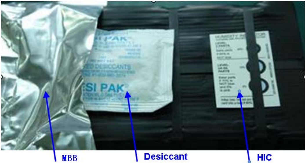
图2-8 干燥真空包装材料示意图
