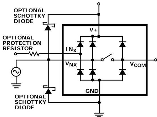
FIGURE 8. OVERVOLTAGE PROTECTION
