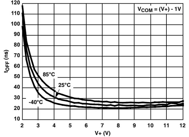
FIGURE 13. TURN - OFF TIME vs SUPPLY VOLTAGE
