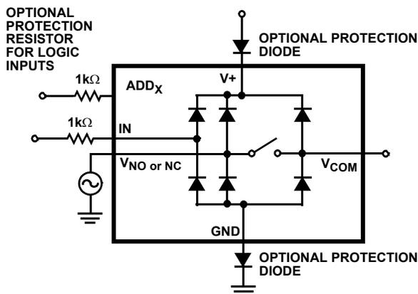
FIGURE 7. OVERVOLTAGE PROTECTION
