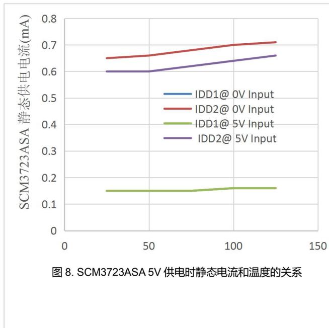
图 8. SCM3723ASA 5V 供电时静态电流和温度的关系
