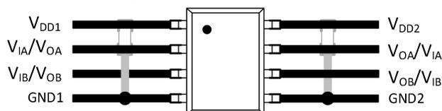
图 11. 推荐印刷电路板布局
