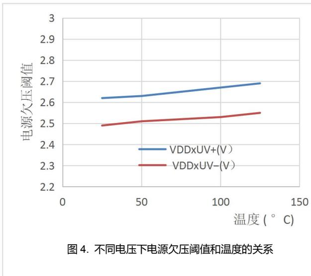
图 4. 不同电压下电源欠压阈值和温度的关系
