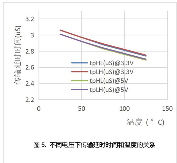
图 5. 不同电压下传输延时时间和温度的关系
