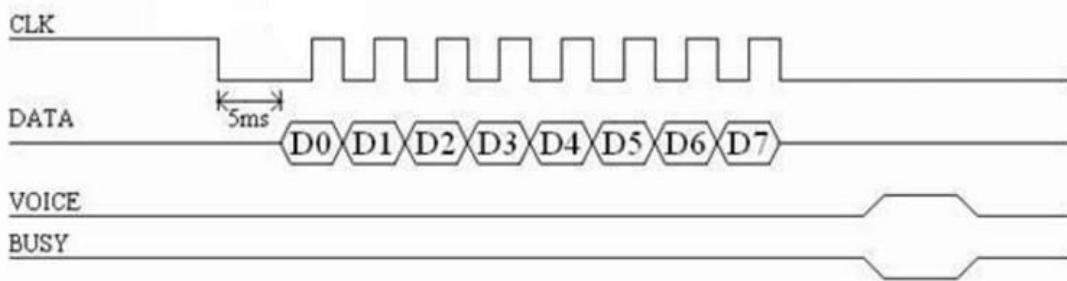
两线串口控制模式由片时钟 CLK 和数据 DATA 进行控制操作，每发一个字节数据前，时钟信号 CLK 拉低 4ms 至 20ms，推荐使用 5ms 以唤醒 WTN6 语音芯片，接收数据低位在先，在时钟的上升沿接收数据。时钟周期介于 40us~3.2ms 之间，推荐周期使用 300us。发数据时先发低位，再发高位。数据中的 00H~CFH 为语音地址指令，E0H~EFH 为音量调节命令，F2H 为循环播放命令，FEH 为停止播放命令。
