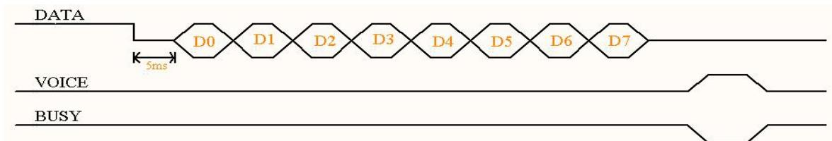
先把数据线拉低 5ms 后, 发送 8 位数据, 先发送低位, 再发送高位, 使用高电平和低电平比例来表示每个数据位的值。
