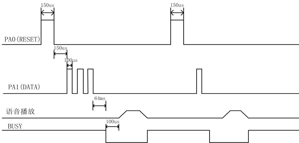
数脉冲控制时序中，先拉高 RESET 信号 150us，然后发送 DATA，DATA 中的脉冲高电平需要保持 100us 的高电平，且两个脉冲之间的间隔时间需要 100us。脉冲数据发送完后 64ms，BUSY 信号输出。BUSY 输出 100us 后开始播放地址语音，语音播放结束 BUSY 也发生变化。
