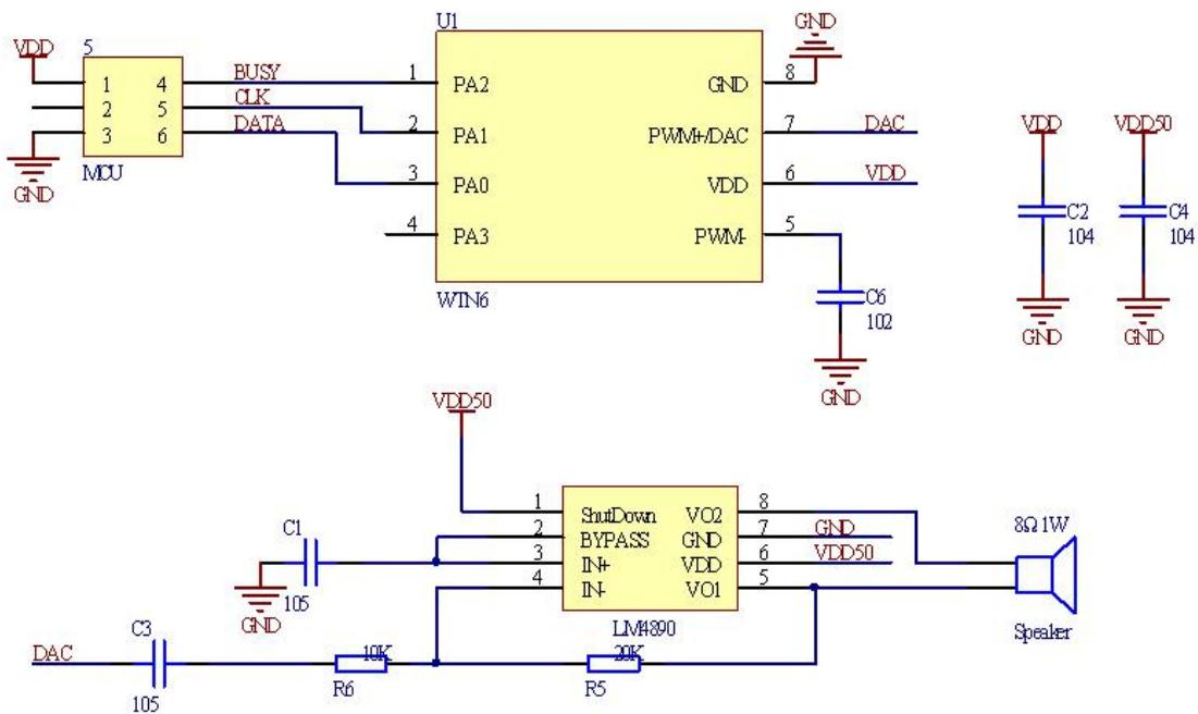
注意：布线时电容 C2 尽量靠近 WTN6 芯片 VDD 脚，以增强 WTN6 系列语音芯片的抗干扰能力。在 DAC 输出模式下，PWM-脚必须接 1nf 电容到地，DAC 输出可根据需求外接功放，以驱动更大功率的喇叭。
