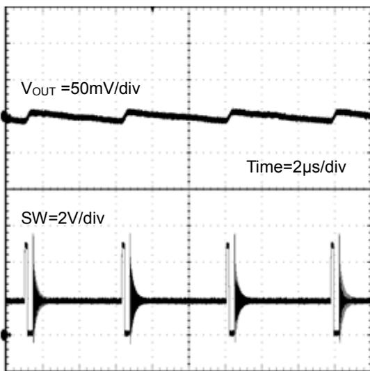
Figure 29. SW Waveform (SLLM™ Control)
