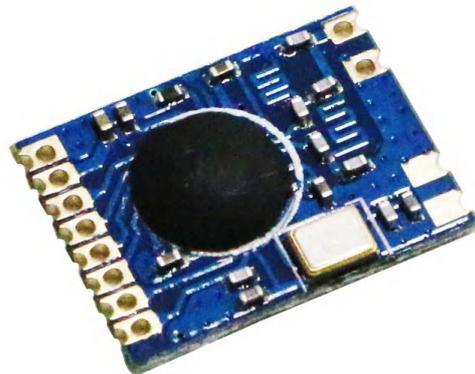
模块采用 SMD、DIP 两种接口模式，但由于黑胶和里面的绑线热胀系数不同，绑定模块需要人工焊接。模块尺寸较小，方便应用于便携式产品，且通过与低功耗 MCU 配合可很好地满足低功耗系统的要求。
