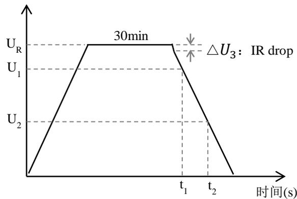
容量计算公式:  $C = I \times \frac{t_2 - t_1}{U_1 - U_2}$
