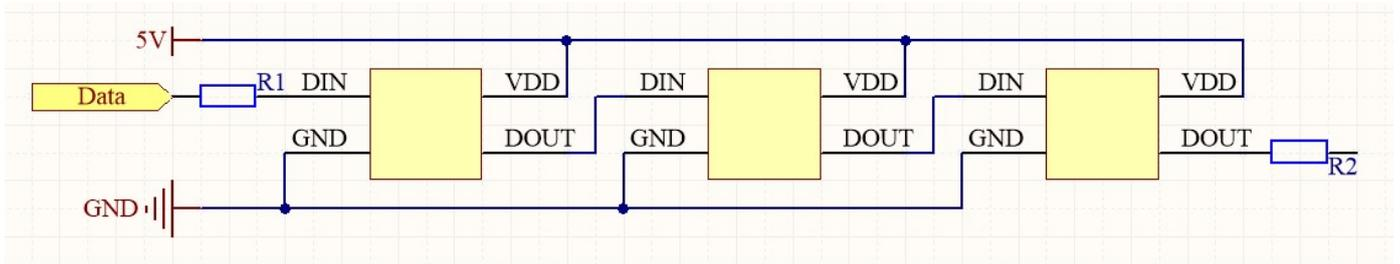
在实际应用电路中，为防止产品在测试时带电插拔产生的瞬间高压损伤IC内部信号输入输出引脚，应在信号输入及输出端串接保护电阻。此外，为了使各IC芯片间更稳定工作，各灯珠间的退偶电容则必不可少；
