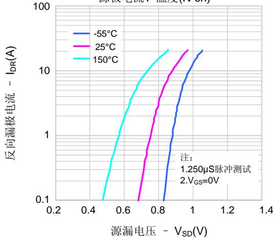
图4.2 体二极管正向压降vs. 源极电流、温度(P-ch)
