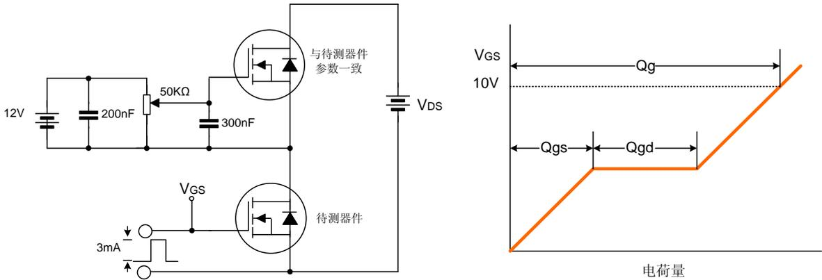
开关时间测试电路及波形图
