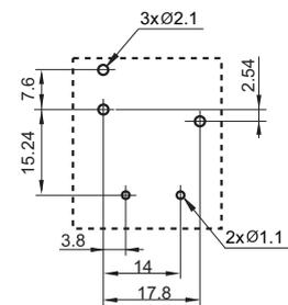
备注: (1) 产品外形图的引脚标注尺寸为沾锡前尺寸(沾锡后会变大), 安装孔尺寸为推荐的PCB板孔的设计尺寸, 具体PCB板孔设计尺寸可根据产品实物进行测绘、调整;
