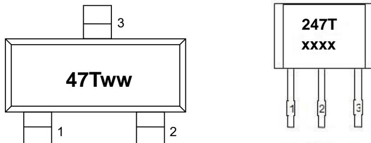
**低功耗全极型超高灵敏 CMOS 输出霍尔开关**
