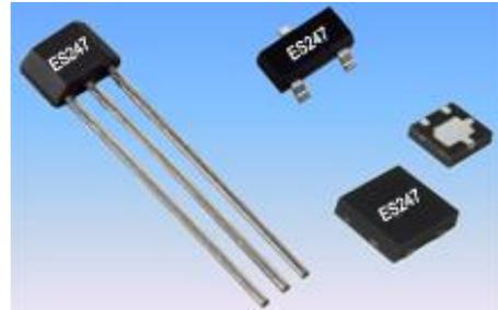
ES247TG 的输出晶体管在面向封装标示的一面存在一定强南极或北极磁场时会被锁定在开(B<sub>OP</sub>)状态,而在无磁场时锁定在关(B<sub>RP</sub>)状态。
