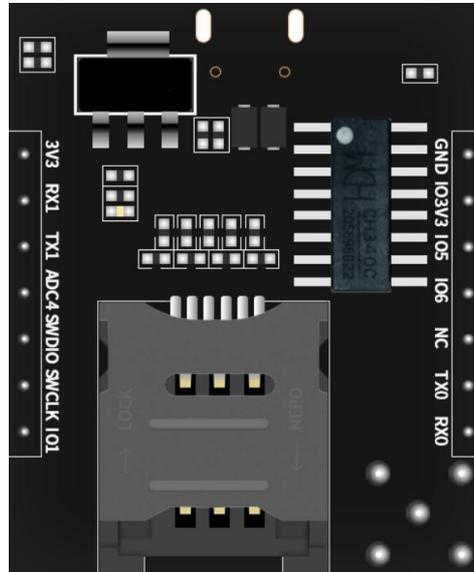
图 6 开发板管脚示意图（底部视图）
