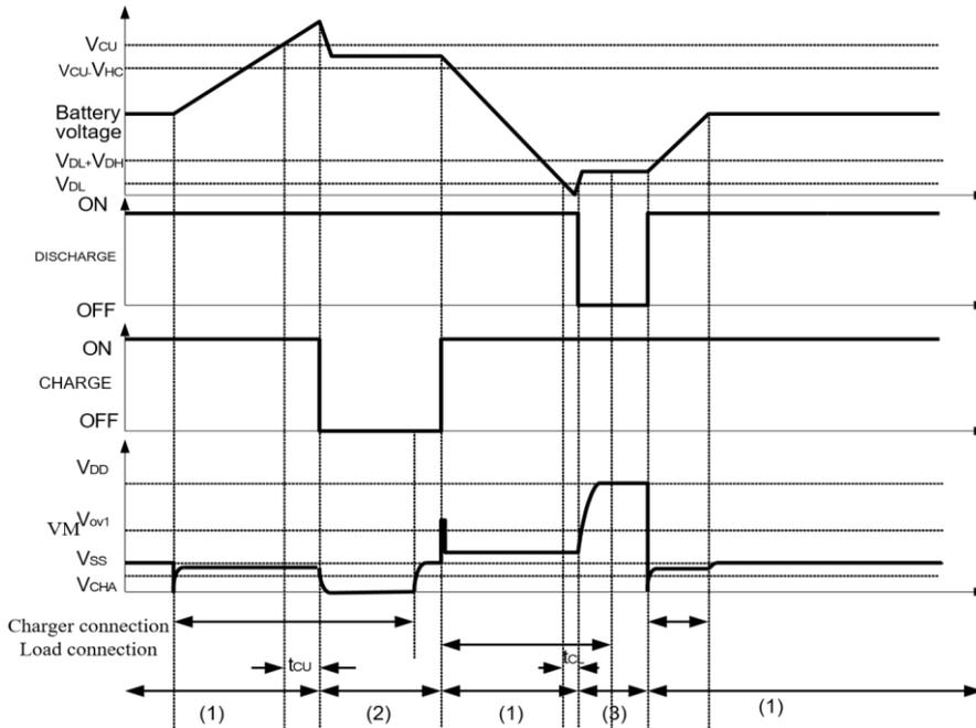
图 5-1 过充电和过放电电压检测
