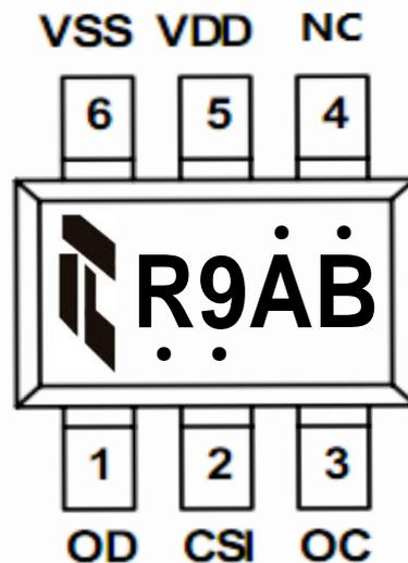
图1 FH201B 的 SOT23-6 封装及引脚排布
