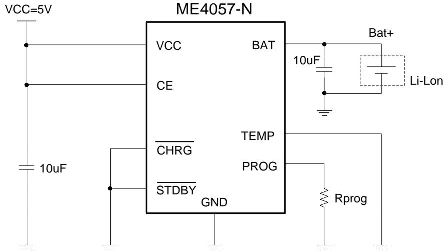
5. 输入端增加一个功率电阻来减少芯片功率损耗。红灯亮表示正在充电状态，绿灯亮便是充电停止状态。
