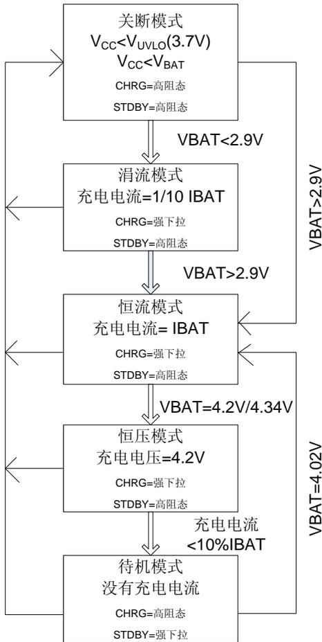
图 1：一个典型的充电循环状态图
