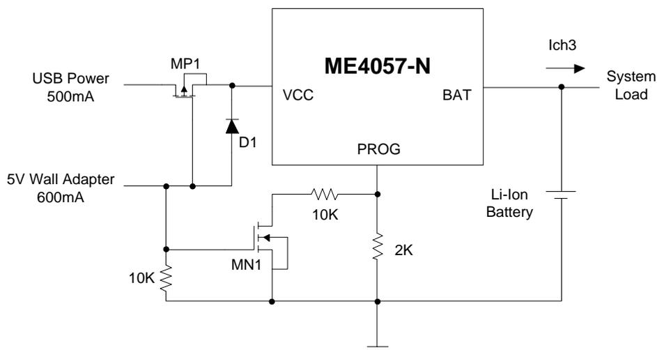
图5：交流适配器与 USB 电源的组合
