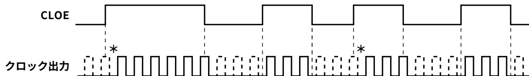
図12-6 リモコン出力応用例
