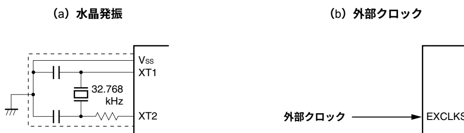
図6-13 XT1発振回路の外付け回路例
