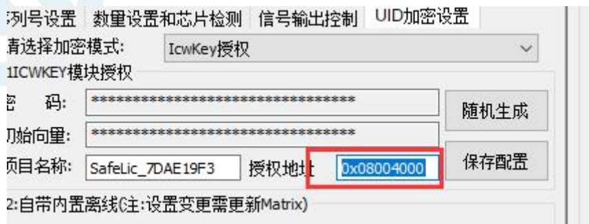
图 4.2.4-5 核对最终项目编译的变量在 Flash 中的地址并更新到 PowerWriter
