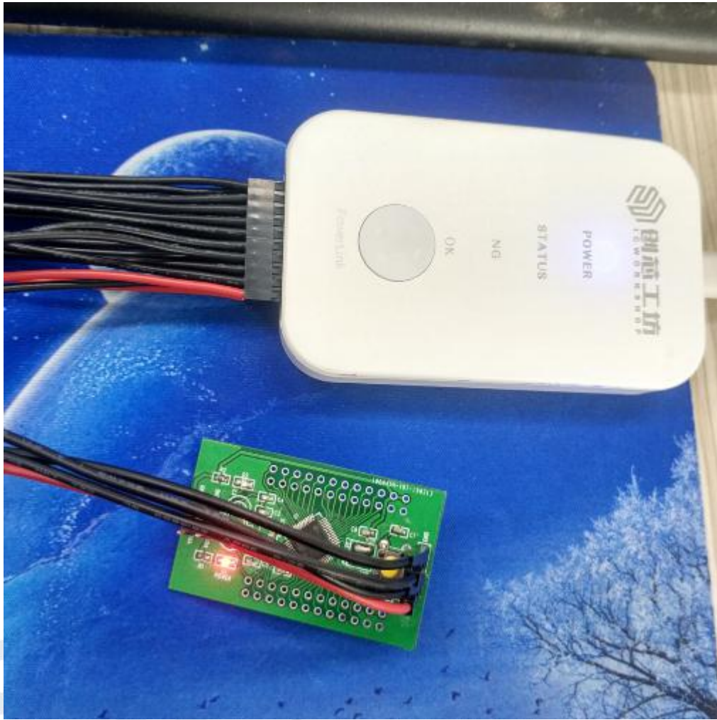
图 4.2.1-1 首先 STM32F071CB 的最小系统板和 Power Writer 连接
