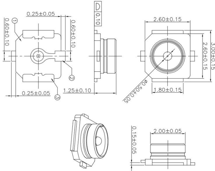
图 9 板端 IPEX 座子尺寸图
