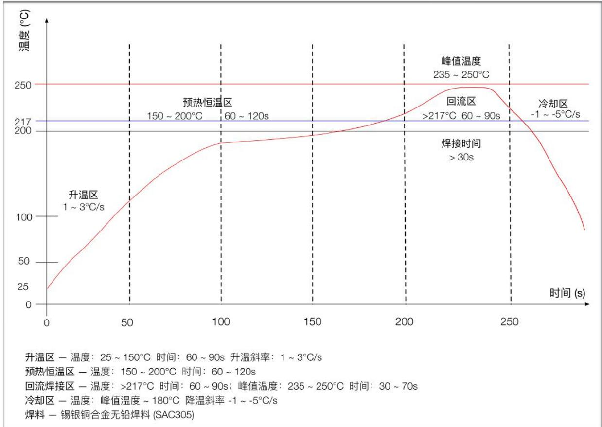
图 12 回流焊曲线图
